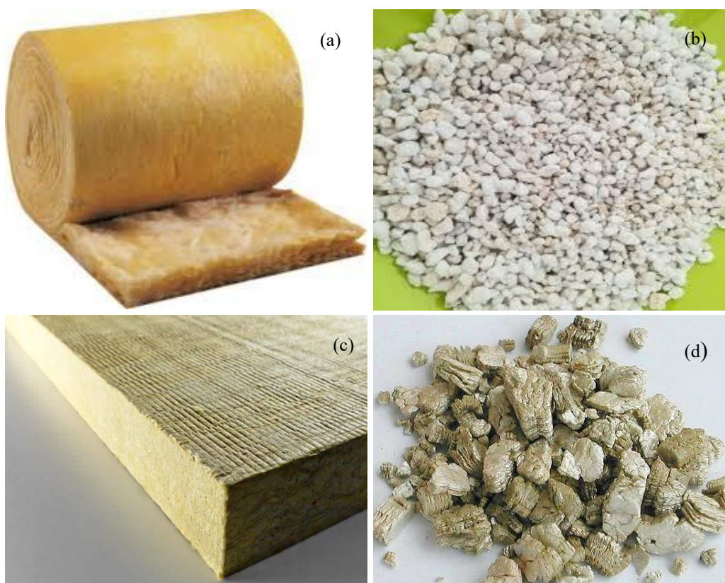
Figure II.8. Mineral insulators (a) : glass wool, (b) : expanded perlite, (c) : rock wool, (d) : expanded vermiculite. Source : (Isolation et chauffage, 2024; Keji, 2023; Knauf Insulation Maghreb, 2024; Health Canada, 2009)
